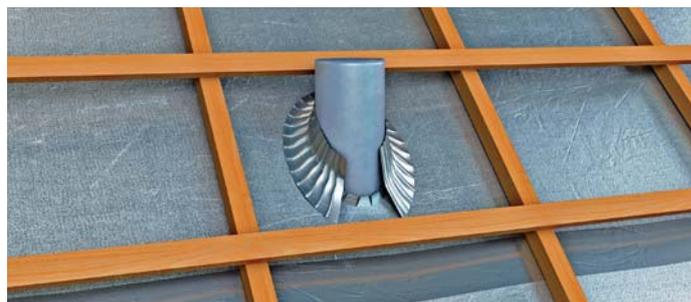
Im Fall einer Verlegung mit Dunstrohr :
