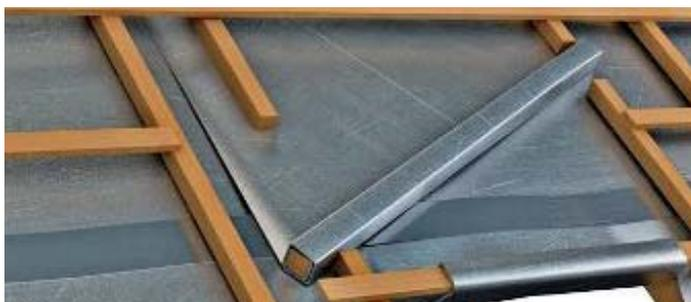
Ein Streifen der oberen Schicht des **SKYTECH PRO XL**, sorgfältig vom Rest der Bahn getrennt, wird in der Breite des Achsabstands des Sparrens, plus 20 cm, zugeschnitten. Dieser Streifen wird in die Überlappung geschoben, die direkt über dem Stichbalken liegt. Eine Dachlatte wird anschließend im Streifen eingewickelt (mindestens 2 volle Drehungen). Diese Dachlatte wird so als Ablenkblech verwendet. Sie wird quer über den unterbrochenen Konterlattens festgenagelt.
